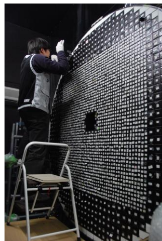
ビームライン (左) と電磁カロリメータ (右) の点検を行っている様子
