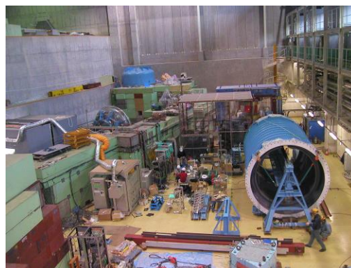
E391a 実験に用いた真空容器をハドロン実験ホールに移設する様子
